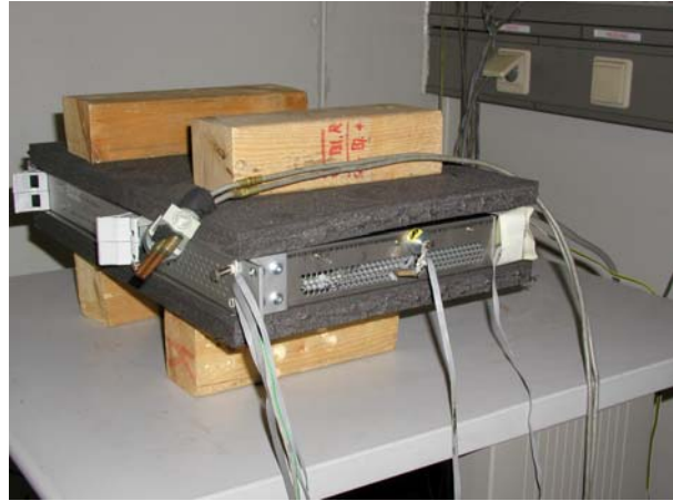
Bild 2: CPCI mit Isolierung oben und unten
